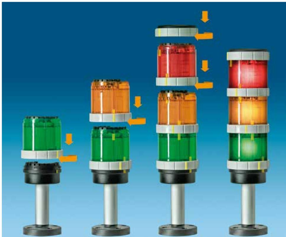
Gli attacchi a baionetta permettono un veloce montaggio della colonna, si posizionano gli elementi con le tacche, presenti sul corpo, allineate e si ruota l'anello di serraggio; i moduli così assemblati sono solidali fra di loro e non necessitano di cablaggi grazie connettori presenti nei moduli.
