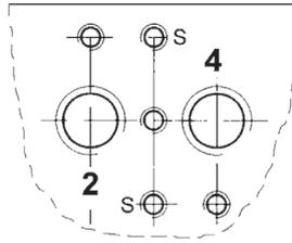
Die Bohrungen „S“ sind für den Kodier-Gewindestift vorgesehen, der in eine Vertiefung des Steuerventils ragt. Der Kodierstift stellt die lagerichtige Zuordnung der Ventilanschlüsse im Austauschfall sicher.
