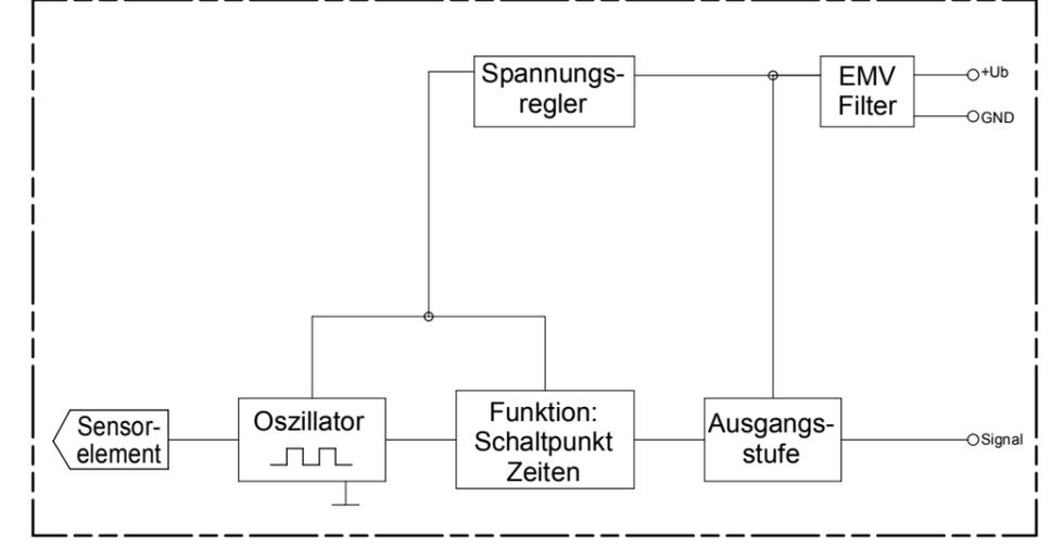
**Funktionsdiagramm für MINIMUM Sonden**
