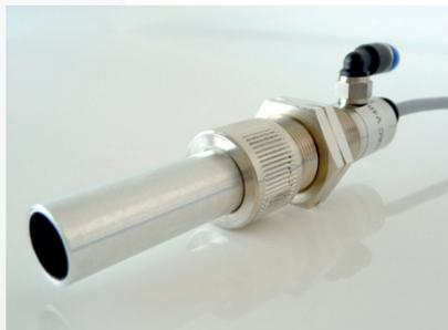
Sehr robuster Sensor für den Einsatz in heißen oder sehr verschmutzten Umgebungen. Luftkühlung und Linsenreinigung per Druckluft, 40 mm Vorsatzrohr gegen Verschmutzung und Störstrahlungen
