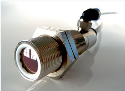
Für den Einsatz in heißen oder verschmutzten Umgebungen. Distanz / Messfleck und Abmessungen wie Sensor IR 502G zusätzlich mit Druckluftanschluss für Luftkühlung und Linsenreinigung
