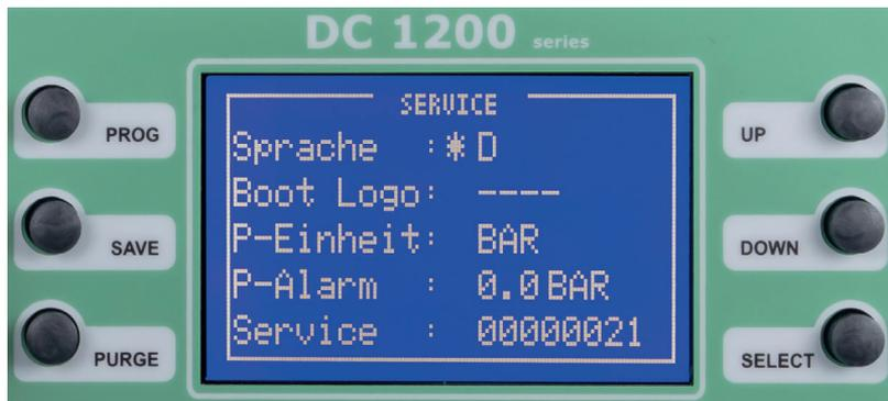
Zum Servicemenü gelangen Sie, wenn Sie beim Einschalten des Gerätes **gleichzeitig** die Tasten UP und DOWN gedrückt halten.
