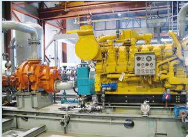
Pumpenantrieb / pump drive
