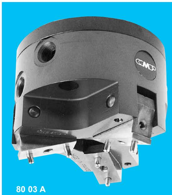
**Pincas cylindriques de précision en alliage léger, 2 mors à ouverture angulaire, serrage concentrique pour application demandant : force de serrage élevée, fiabilité, interchangeabilité, souplesse.**
