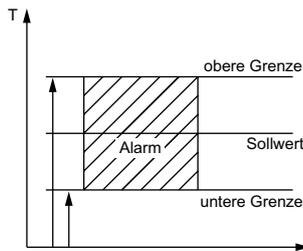
Umgekehrtes Schaltverhalten wie beim Grenzwertalarm. Lampe 3 leuchtet bzw. Kontakt K3 ist angezogen, wenn der Istwert innerhalb der eingestellten Grenzwerte liegt.
