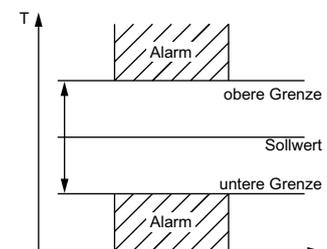
Sollte der Istwert außerhalb der eingestellten Temperaturgrenzen liegen, also oberhalb des oberen Grenzwertes oder unterhalb des unteren Grenzwertes, so ist der Alarmkontakt aktiv.
