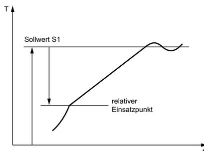
Der Hauptsollwert S1 und der Rampeneinsatzpunkt sind als Differenz miteinander verknüpft. Diese Differenz kann positive oder negative Werte annehmen, der Startpunkt für die Rampe kann also bei Kühlfunktion oberhalb und bei Heizfunktion unterhalb vom Sollwert angesiedelt werden und läuft beim Verstellen des Sollwertes selbständig mit.
