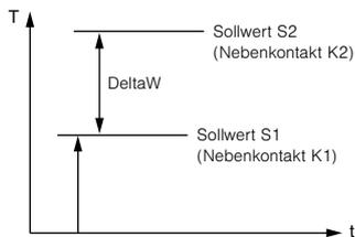
Die Kontakte K1 und K2 sind über eine Schaltdifferenz Delta W miteinander verknüpft (Betrieb mit Delta W).
