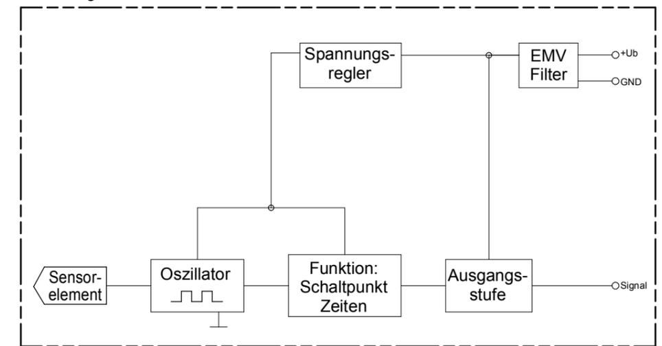
**Funktionsdiagramm für MINIMUM Sonden**
