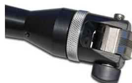
Die Achse unterstützt die gleichmäßige Kraftverteilung über den gesamten Bereich des Schneidkörpers und gestaltet die erzielten Ergebnisse weniger anwenderabhängig. Viele Anwender empfinden die Anwendung der Gitterschnittprüfung hiermit als wesentlich ermüdungsfreier und somit komfortabler!
